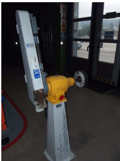
Lijadora de banda y disco 800x250 m/m SUPER LEMA BP-2 Ref: 17834
