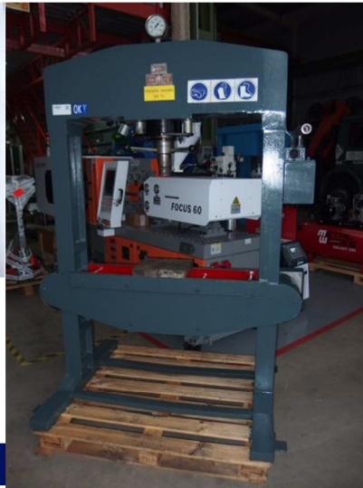
Prensa hidráulica cilindro fijo 60 ton. ANFE 60 ton Ref: 17827
