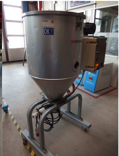
Estufa sobretolva 35 kgs con bancada. Calorifugada C.G.E DME 35 Ref: 17701
