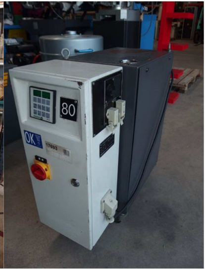
Atemperador molde agua 9 kw. Presurizado REGLOPLAS AG P140/9/SG51/1K/RT45 Ref: 17693
